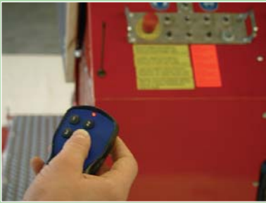
Mando a distancia por radio con alcance de 25 m
