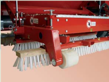
Unidad de cepillos para introducir la carga y levantar la fibra
