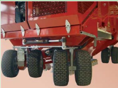
4 pares de ruedas facilitan las maniobras con una presión mínima sobre el pavimento
