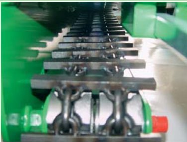
Cadena de oruga extra ancha (140 mm) para su empleo en todo tipo de subbases
